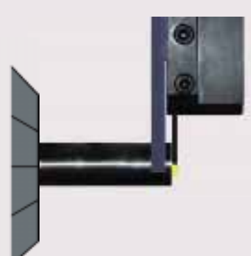
Si aprono i morsetti del mandrino e si estrae la barra fino alla posizione impostata.
