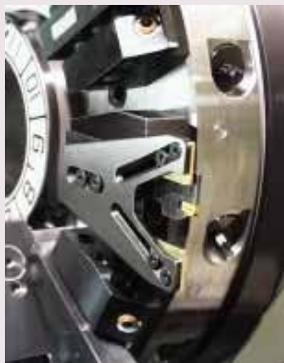
PULLEX non occupa posti utensile in torretta
