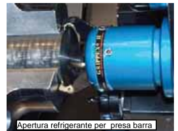
Apertura refrigerante per presa barra
