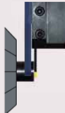
Si fa avanzare PULLEX un poco oltre il centro barra per afferrarla.
