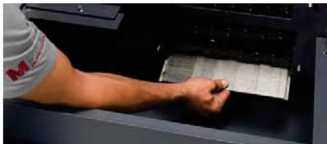
// Opzione intelligente: convogliatore a nastro cernierato o a nastro raschiante in area di lavoro e convogliatore a nastro raschiante per la preseparazione a 500-300 µm con rimozione trucioli ed evacuazione tramite setaccio di separazione nella vasca supplementare
